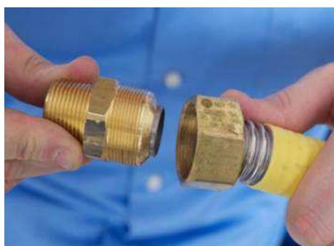
De AutoFlare<sup>®</sup> fitting wordt nu handmatig in de wartelmoer geschroefd. Met geschikte sleutels wordt de moer verder aangedraaid tot de fitting vast zit en de aanspanweerstand sterk toeneemt. Om de verbinding tot stand te brengen wordt de wartelmoer tenslotte nog 1/3 slag of twee moervlakken verder aangedraaid. Nu is de boord van de TracPipe<sup>®</sup> buis opgetrompt en heeft men een metaal op metaal dichting.
