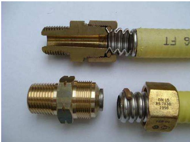
Bij het monteren wordt de laatste golving van de TracPipe® buis opgetrompt en bekomt men een gasdichte metaal op metaal verbinding met een uitstekende weerstand tegen hoge temperatuur (RHT).
